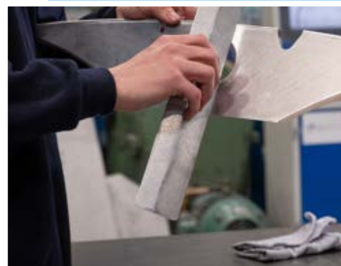
Chaudronnier aéronautique : contrôle de la planéité d'une pièce métallique ↕
