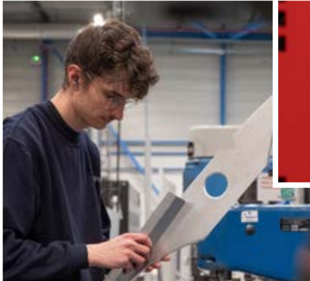
Contrôle de la planéité d'une pièce en chaudronnerie →
