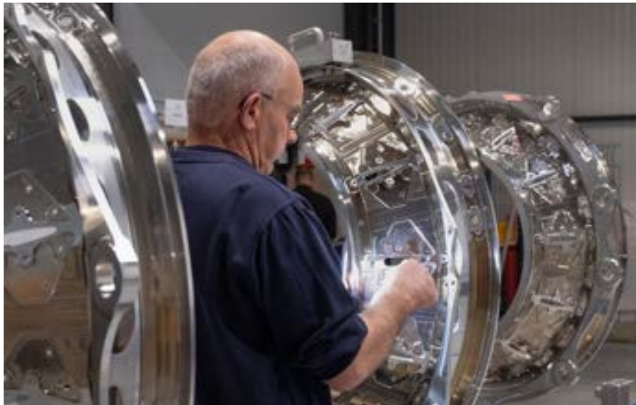
↑ Ébavurage fin et contrôle qualité sur un carter en inox
