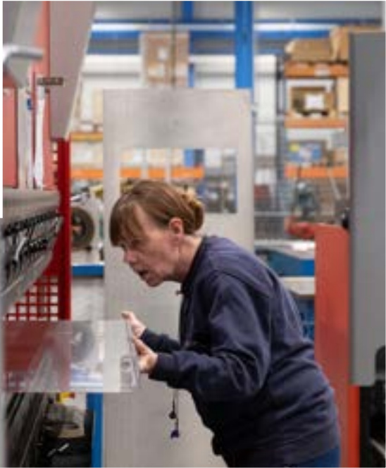
↑ Opération de pliage d'une pièce métallique
