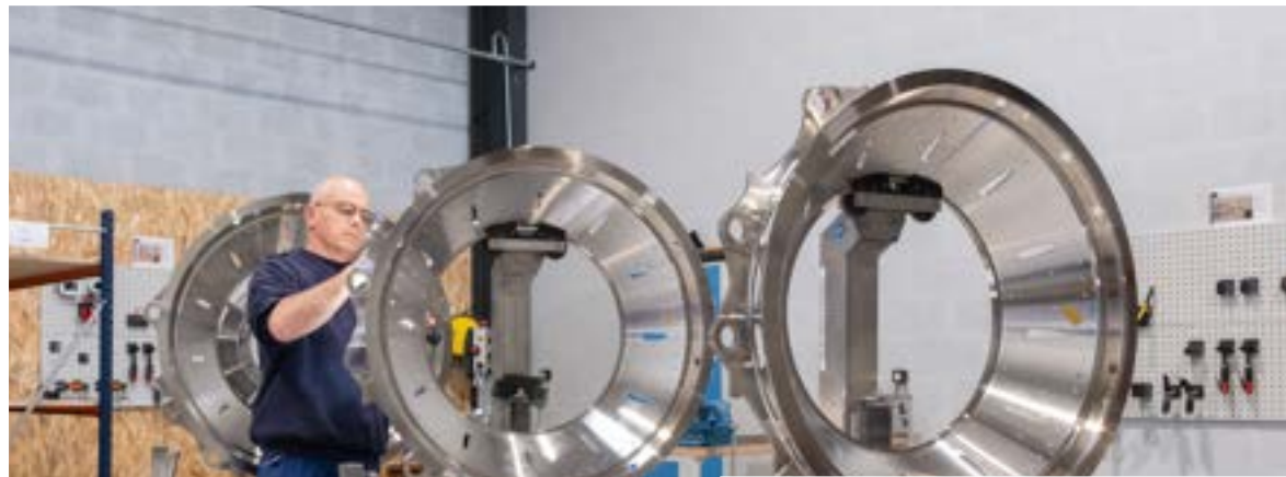
↔ Ébavurage fin et contrôle qualité sur un carter en inox
