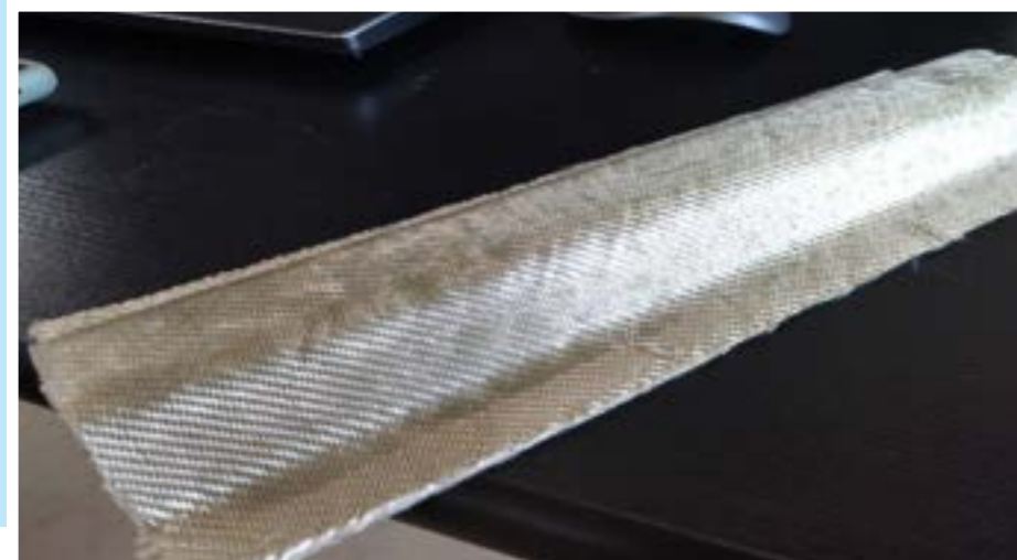
Préforme de raidisseur composite à base de matériaux thermoplastiques innovants
