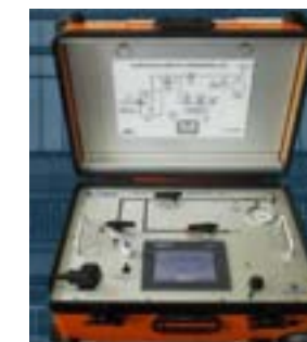
De la taille d'une petite mallette, ce dispositif compact permet de tester des systèmes de commande de vol. Il mesure comment un mécanisme réagit à des mouvements ou des signaux, et vérifie sa résistance face aux contraintes. ↓
