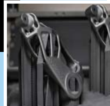
Pièce métallique issue de la fabrication additive (à gauche : dessin CAO / en bas : pièce physique maintenue par des bandes de support)
